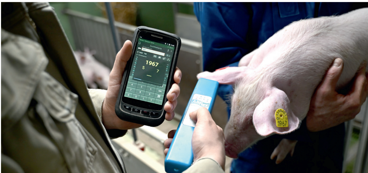
Die eingescannte Ohrmarke wird sofort erkannt und die Daten werden zum Tier geladen.
