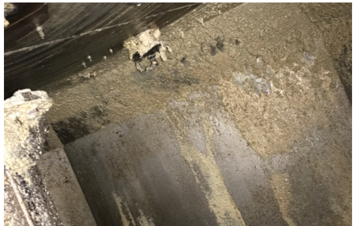
Abb. 5: Anmischbehälter bei einem Betrieb mit hohen Verlusten infolge HIS
